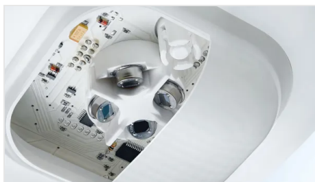
4 pyrodétecteurs numériques avec DSP (Digital Signal Processing)
